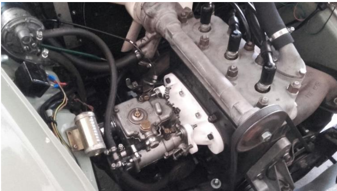
Der erste Einbauversuch des mit 3D-Druck gefertigten Ansaugkrümmers (weiß) im Motorraum.
